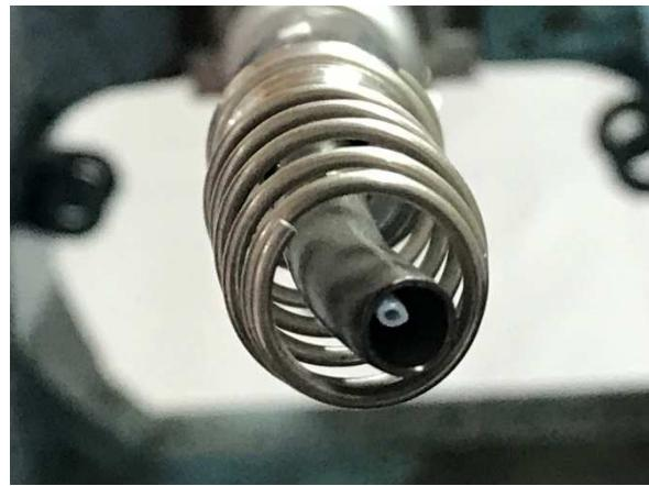
10. Den schwarzen Trichter sowie den Reinigungsbecher wieder aufschrauben und das Gerät mit und ohne Flüssigkeit testen.
