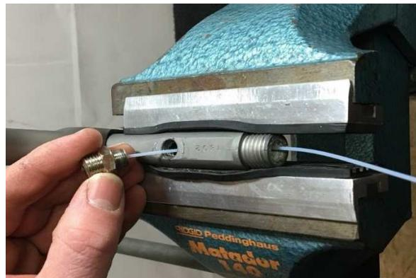
5. Im Griffstück befindet sich jetzt nur noch die Verschraubung des inneren Schlauches. Diese mit dem 14er Schlüssel abschrauben und den defekten inneren Schlauch entnehmen.
