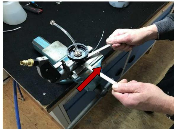
4. Mit dem 14er Schlüssel die Verschraubung des inneren Schlauches fixieren und mit dem 16er Schlüssel den Umschalter und den darunter befindlichen Deckel abschrauben.
