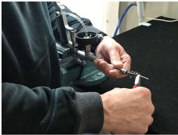
9. Ziehen Sie nun das Rotationsset zurück (Richtung Griff) und schneiden den überstehenden Schlauch bündig ab. Im Betrieb ist der Schlauch damit etwa 1-2mm kürzer als das Rotations-Set. Das ist für eine einwandfreie Funktion erforderlich.
