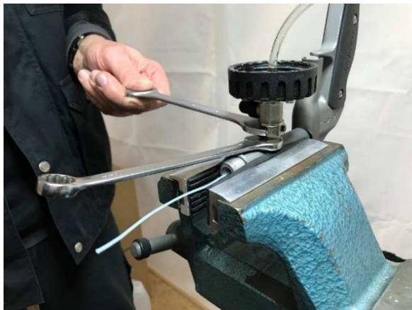
3. Mit dem 16er Maulschlüssel den Umschalter leicht lösen, bis der 14er Schlüssel auf die Spannfläche der Verschraubung des inneren Schlauches passt.
