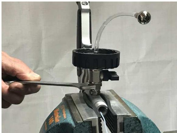
7. Umschalter und Deckel wieder montieren.
